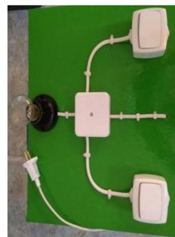
Соединяются провода в соединительной коробке по схеме рисунка 3.
